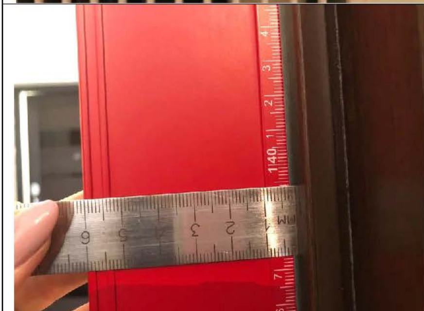
Фото №17. Отклонение наличника дверного блока кухни в квартире.
